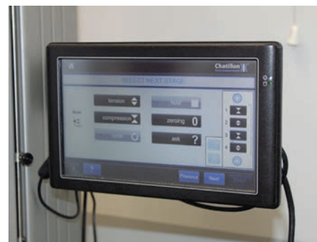
Fig. 2: Monitor para la variación de los parámetros en los ciclos específicos de prueba
